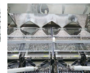
サプリメント計数機 充填前に内容量を正確に数えます
